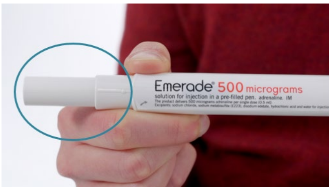
Bild 2. Aktiverad. När pennan har aktiverats kommer nålskyddet att skjuta ut och låsas.
