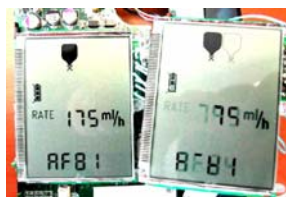
Bild 1. Den vänstra displayen visar en normal display medan den högra visar en display som behöver bytas.
